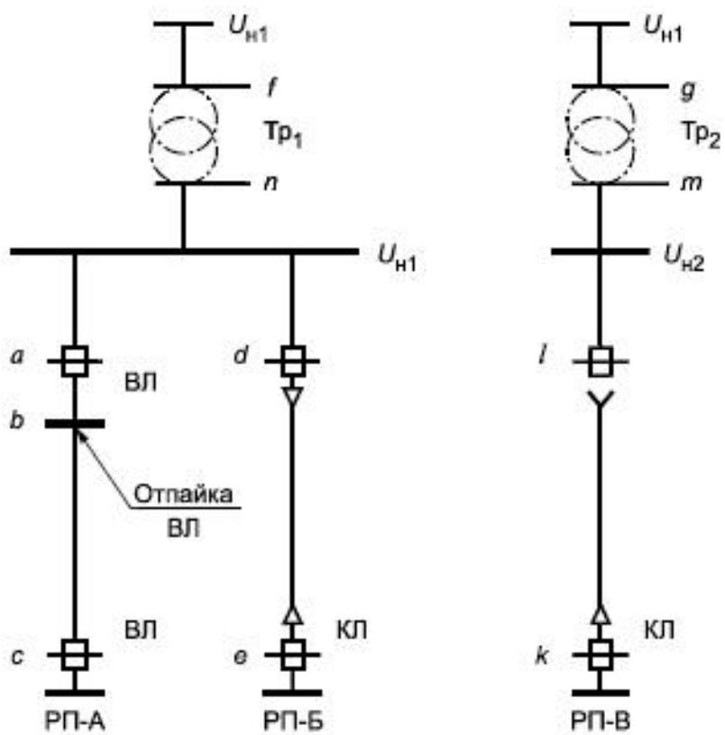
ВЛ - воздушная линия; КЛ - кабельная линия; РП-А, РП-Б, РП-В - распределительные подстанции; Тр<sub>1</sub>, Тр<sub>2</sub> - силовые трансформаторы;  $U_{H1}$ ,  $U_{H2}$  - напряжения на первичной и вторичной обмотках силового трансформатора; а, б, с, д, е, ф, г, к, л, м, н - возможные точки присоединения к электрической сети
